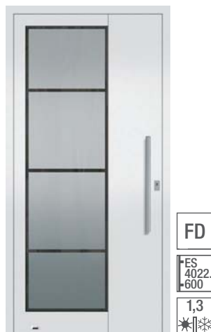
K38300 geteilte Sprosse 90 mm, Verglasung: Wärmeschutzisoliertglas, vorne: VSG mattiert mit klarem Rand und klaren Strei- fen, hinten: Float beschichtet, Oberfläche: Feinstruktur ca. RAL 9016.
