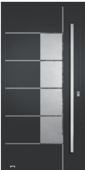
5332 Stoßgriff auf Füllung montiert, vorne: VSG mattiert mit klaren Streifen, hinten: Float beschichtet, Lisenen in NIRO-Design nicht flächenbündig, Oberfläche: DB 703 FSM
