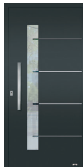
5341 Stoßgriff auf Füllung montiert, vorne: VSG mattiert mit klaren Streifen, hinten: Float beschichtet, Lisenen in NIRO-Design nicht flächenbündig, Oberfläche: ca. RAL 9005 Deep Black FS
